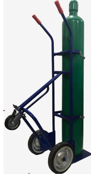
Şekil 4. Azot tüpü ve taşıma aracı
