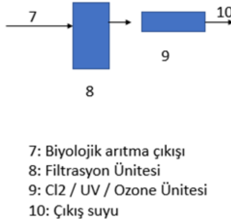
Şekil 25 Önerilen İleri Arıtma Tesisi Şeması
