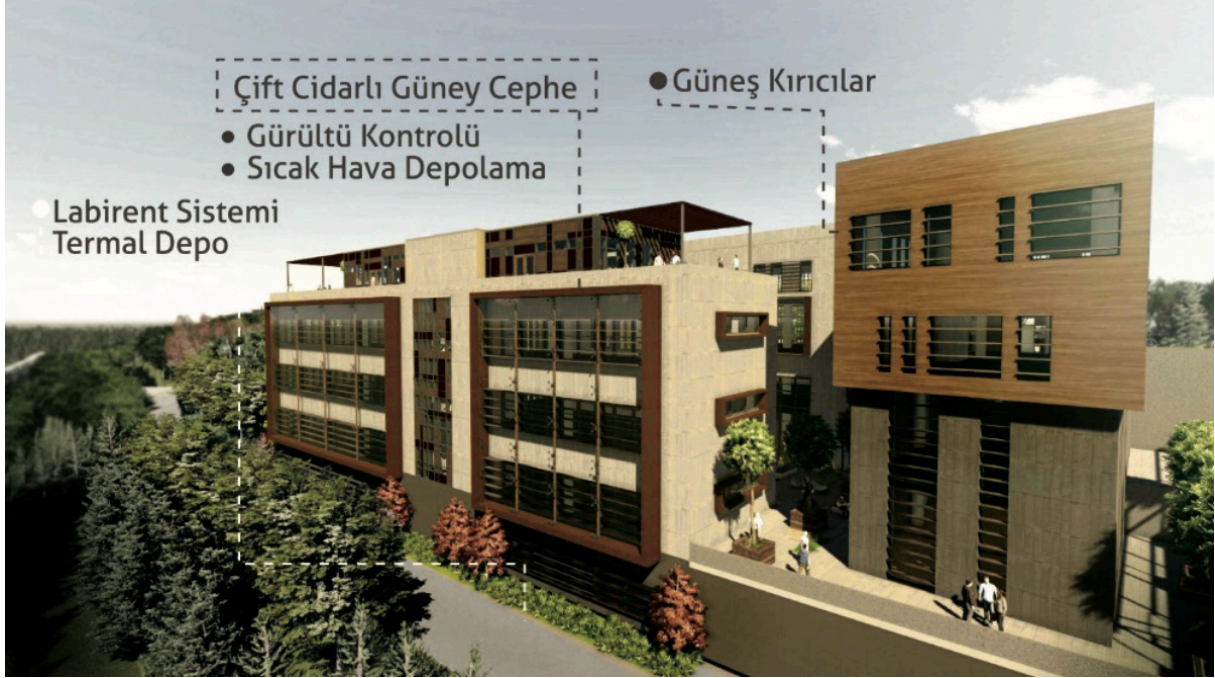
Şekil 15. Çift cidar örnek uygulama
