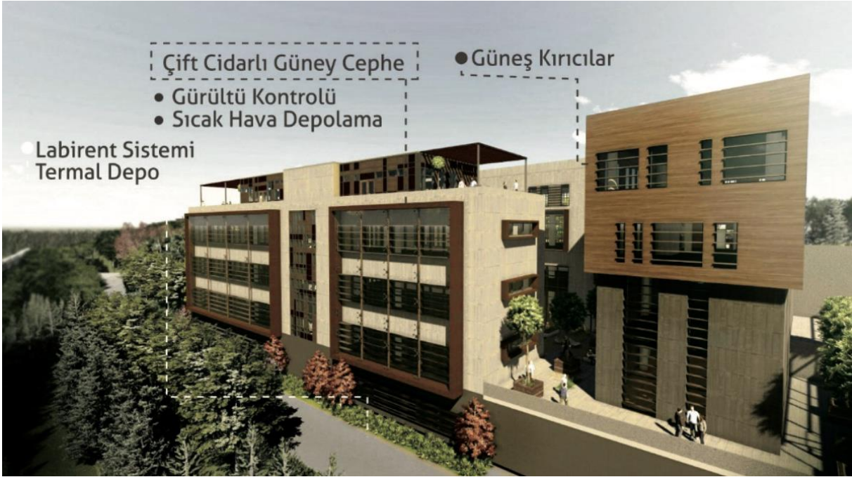
Şekil 15. Çift cidar örnek uygulama
