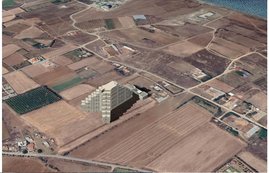
Şekil 13 konutların Aralık ayı içerisinde Öğleden sonra 14.00 itibarı ile yansıttığı gölge çalışması
