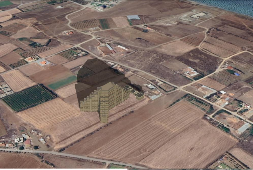
Şekil 12 konutların Aralık ayı içerisinde Öğlen 12.00 itibarı ile yansıttığı gölge çalışması
