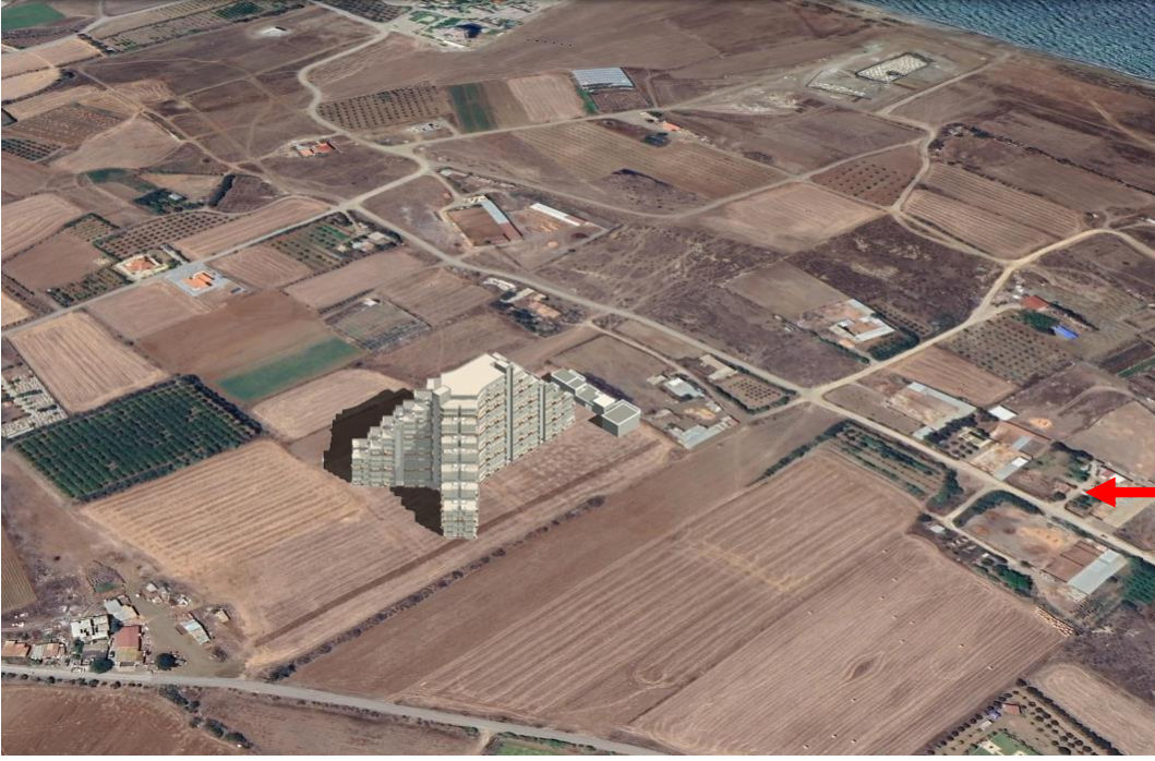
Şekil 9 konutların Haziran ayı içerisinde Öğlen 12.00 itibarı ile yansıttığı gölge çalışması
