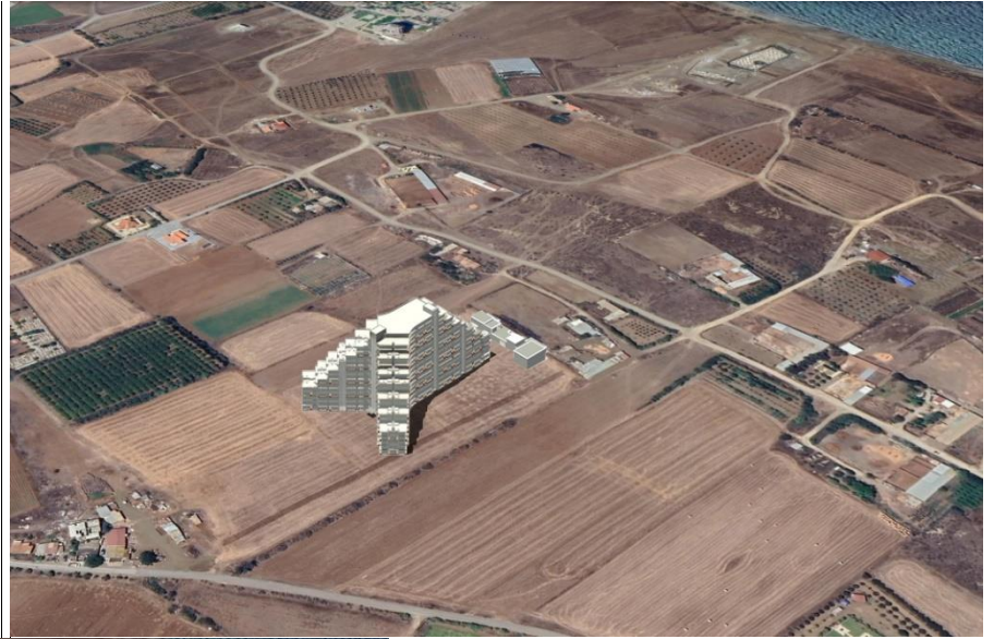
Şekil 10 konutların Haziran ayı içerisinde Öğleden sonra 14.00 itibarı ile yansıttığı gölge çalışması
