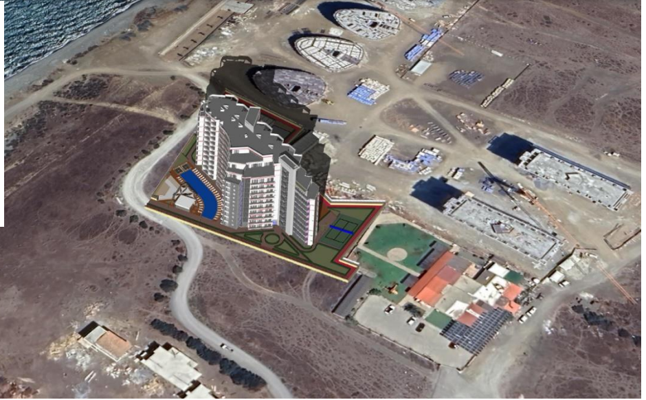
Şekil 13 konutların Aralık ayı içerisinde Öğleden sonra 14.00 itibarı ile yansıttığı gölge çalışması
