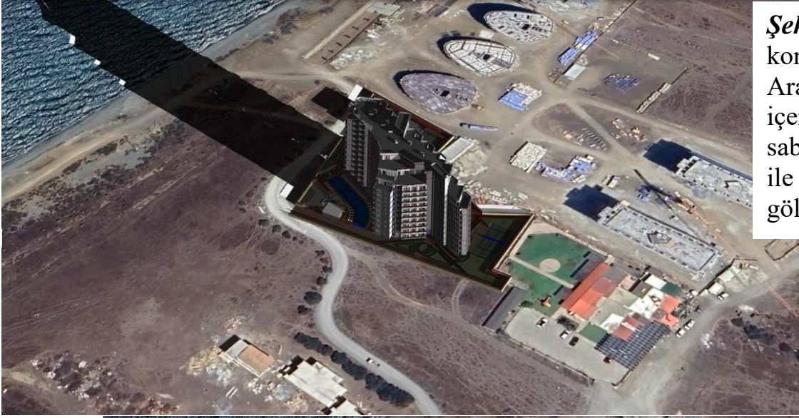
Şekil 12 konutların Aralık ayı içerisinde Öğlen 12.00 itibarı ile yansıttığı gölge çalışması
